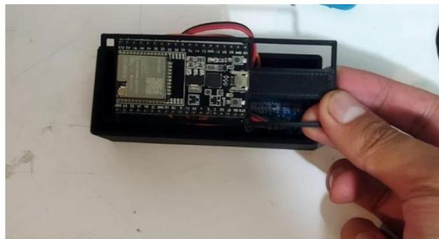
*Nota.* Al colocar se debe evitar que los cables queden atrapados en las partes de case ubicándolos de la mejor manera.
