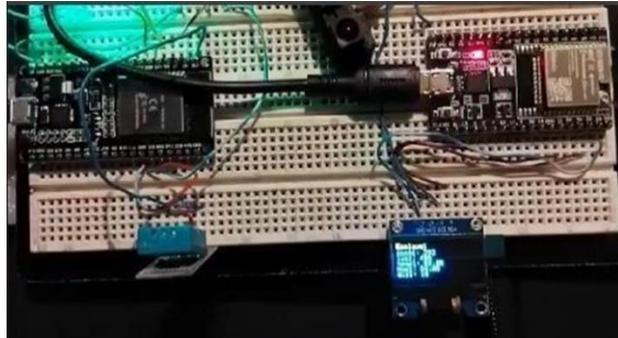
*Nota.* Se debe asegurar de que el sensor DTH11 este correctamente conectado pues este puede evitar que la comunicación 'Wi-Fi' se inicialice correctamente.
