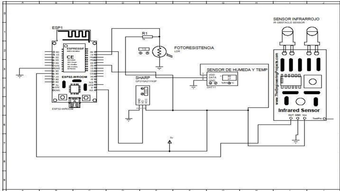
*Nota.* Se observa el diagrama con sus conexiones de los sensores con cada puerto del Arduino.
