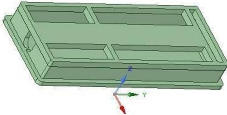
*Nota.* Diseño de divisiones del case parte trasera en las cuales colocamos el Arduino y sus microsensores.
