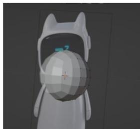
*Nota.* El modificador "Simetría" refleja una parte del objeto a lo largo de un eje específico, elaboración propia.
