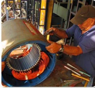
*Nota.* En la imagen se muestra el proceso de rebobinado de un motor eléctrico. Reproducido de Instalaciones Eléctricas, por HVH, 2020 (<https://hvhindustrial.com/es/blog/Tipos-de-Motores-El%C3%A9ctricos>).
