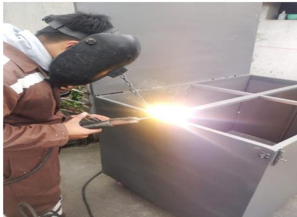
*Nota.* En la imagen se muestra el soldado de la cadena para el soporte de la tapa del horno.
