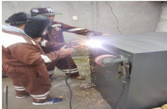
*Nota.* En la imagen se muestra la colocación de las ruedas en la parte inferior del horno.
