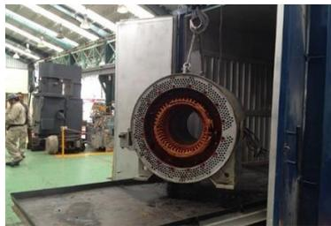
*Nota.* En la imagen se muestra el proceso realizado para el secado de motores eléctricos utilizando hornos eléctricos. Reproducido de Instalaciones Eléctricas, por HVH, 2020 (<https://hvhindustrial.com/es/blog/Tipos-de-Motores-El%C3%A9ctricos>).
