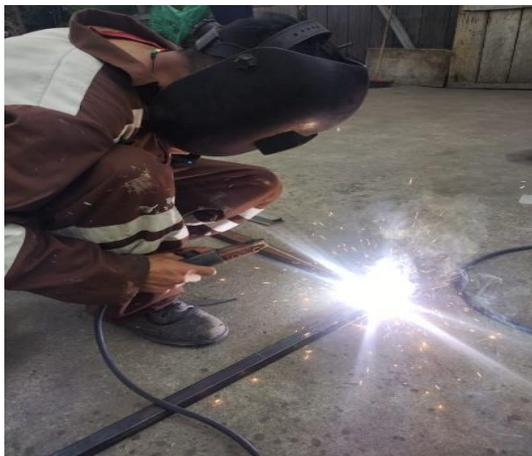
*Nota.* En la imagen se muestra el proceso de soldadura empleado para la unión de las bases rectangulares.
