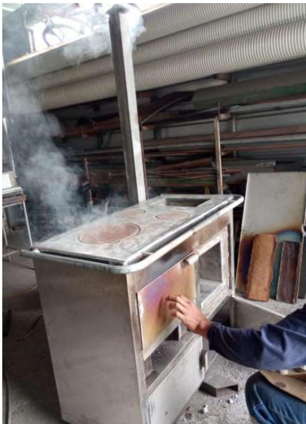
**Nota:** Verificación visual del funcionamiento de la cocina, corrección de fugas
