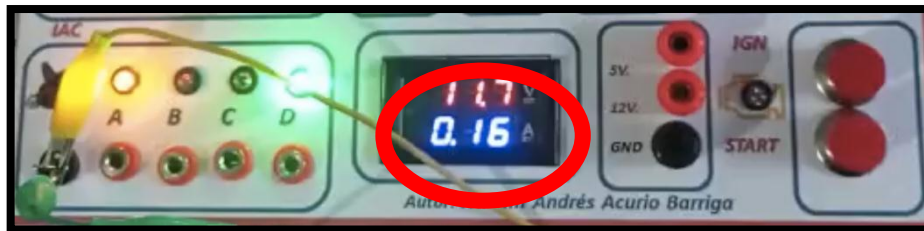
Figura No. 28 Prueba de conexión encendido satisfactoria. Elaborado por: William Andrés Acurio Barriga Fuente: Datos de la investigación.
