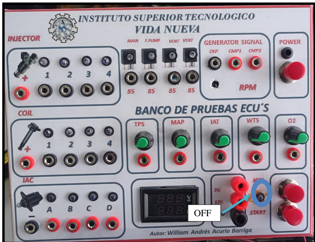
Figura No. 25 Testigo módulo apagado led en estado intermitente.
