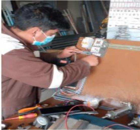
*Nota.* Alimentación del motor para la banda transportadora, para luego proceder con las pruebas de funcionamiento.
