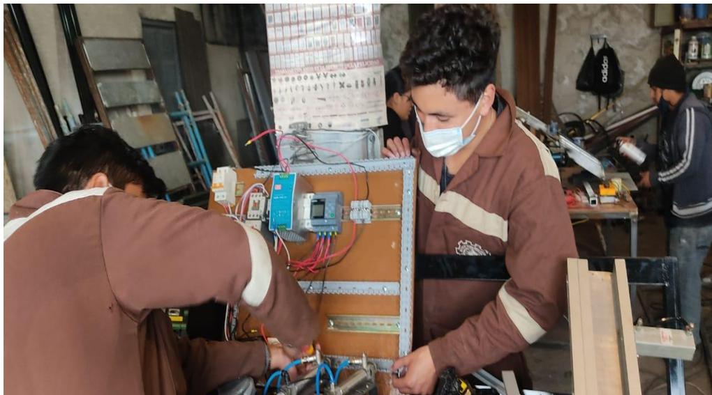
*Nota.* Ubicación e instalación de los elementos de control como el Arduino y el relé programable.
