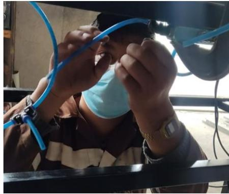
*Nota.* Ubicación y conexión de la manguera neumática para los distintos pistones y electroválvulas (2022).
