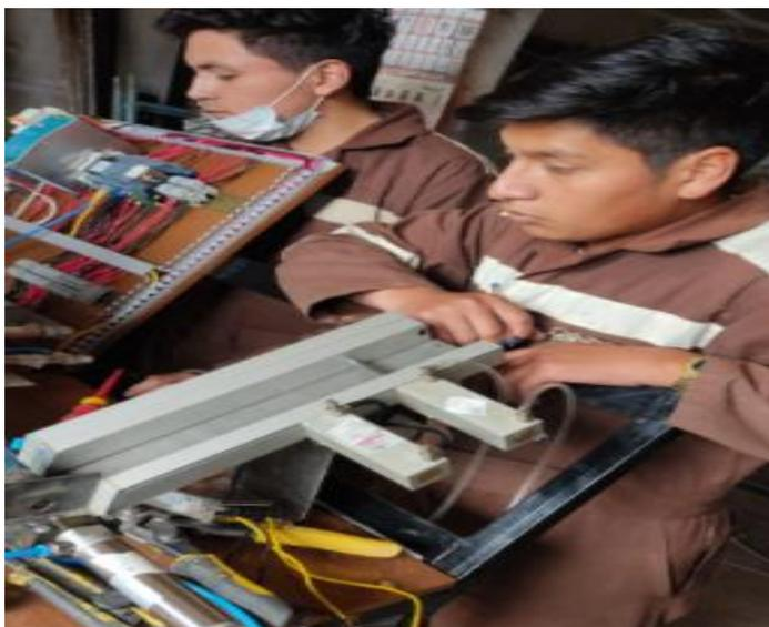
*Nota.* Calibración de la salida y entrada del vástago del pistón para que la materia prima no sufra daños.
