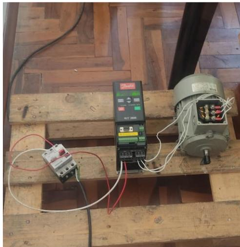
*Nota.* La figura muestra la conexión del motor trifásico e cual está conectado a un variador para poder controlar su velocidad.
