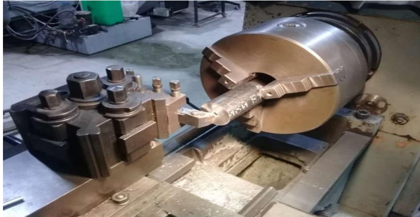
Figura 17. Fabricación de la pieza de desbaste en el torno.
