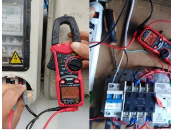
Imagen No. 31 Comprobación de voltaje Elaborado por: Lenin Fernando Perez Mendoza Fuente: Datos de la investigación
