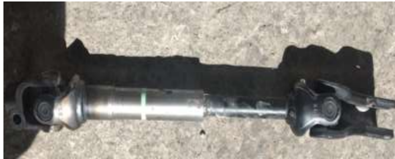
Imagen No. 20 Eje de crucetas Elaborado por: Alejandro Israel Huilca Serrano Fuente: Elaboración propia
