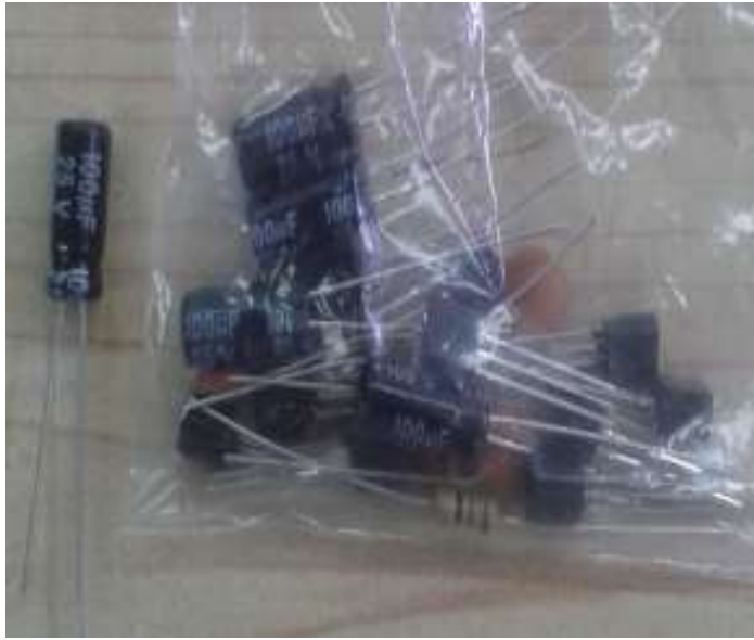
Imagen No. 35 Capacitores Elaborado por: Alejandro Israel Huilca Serrano Fuente: Elaboración propia
