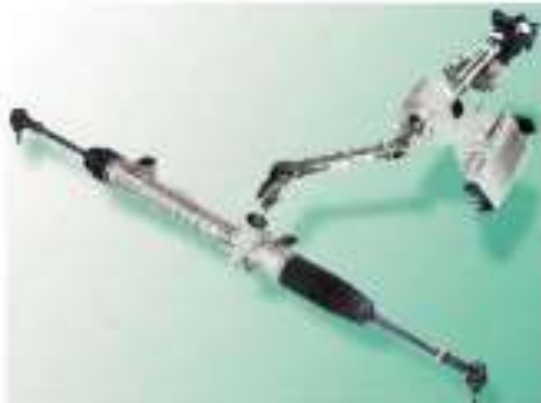
Imagen No. 1 Dirección asistida eléctricamente a través de un motor situado en la columna de dirección Elaborado por: Alejandro Israel Huilca Serrano Fuente: Águeda, García, & Gómez (2014).
