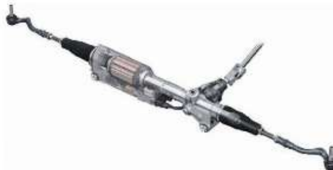
Imagen No. 4 Posicionamiento del motor eléctrico sobre la caja de dirección Elaborado por: Alejandro Israel Huilca Serrano Fuente: Águeda, García, & Gómez ( 2014).
