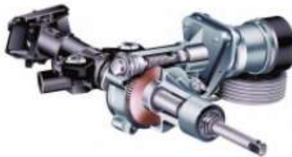
Imagen No. 14 Motor eléctrico acoplado a la columna de dirección Elaborado por: Alejandro Israel Huilca Serrano Fuente: Águeda (2020) .
