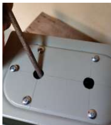
Imagen No. 19 Limado del gabinete Elaborado por: Cristian Daniel Suntasig Flores Fuente: Datos de la investigación
