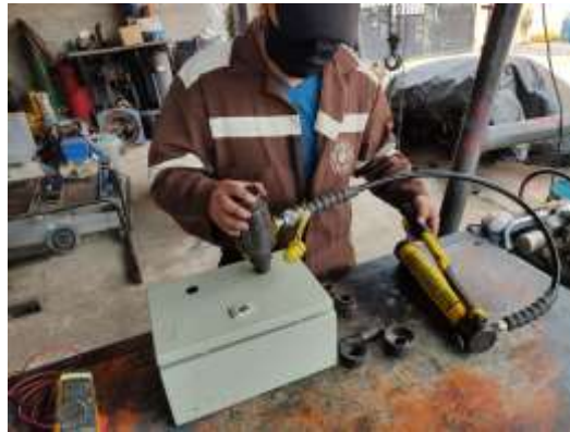
Imagen No. 20 Perforación para las luces piloto Elaborado por: Cristian Daniel Suntasig Flores Fuente: Datos de la investigación
