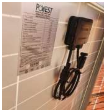
Imagen No. 21 Identificación de los conectores del panel Elaborado por: Cristian Daniel Suntasig Flores Fuente: Datos de la investigación
