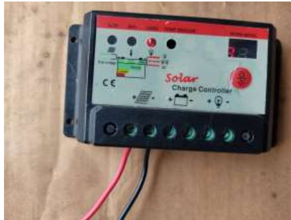
Imagen No. 22 Conexión del panel al controlador Elaborado por: Cristian Daniel Suntasig Flores Fuente: Datos de la investigación
