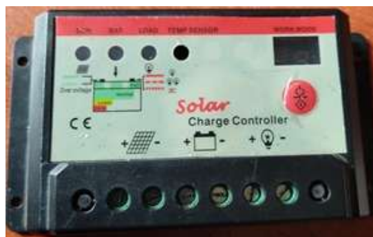
Imagen No. 9 Controlador de carga Elaborado por: Cristian Daniel Suntasig Flores Fuente: Datos de la investigación
