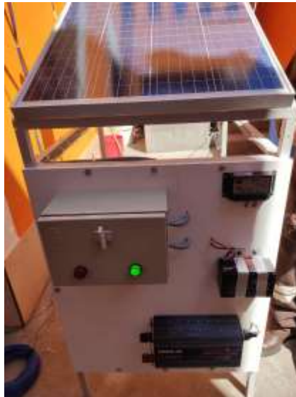
Imagen No. 38 Comprobación del sistema de transferencia Elaborado por: Cristian Daniel Suntasig Flores Fuente: Datos de la investigación
