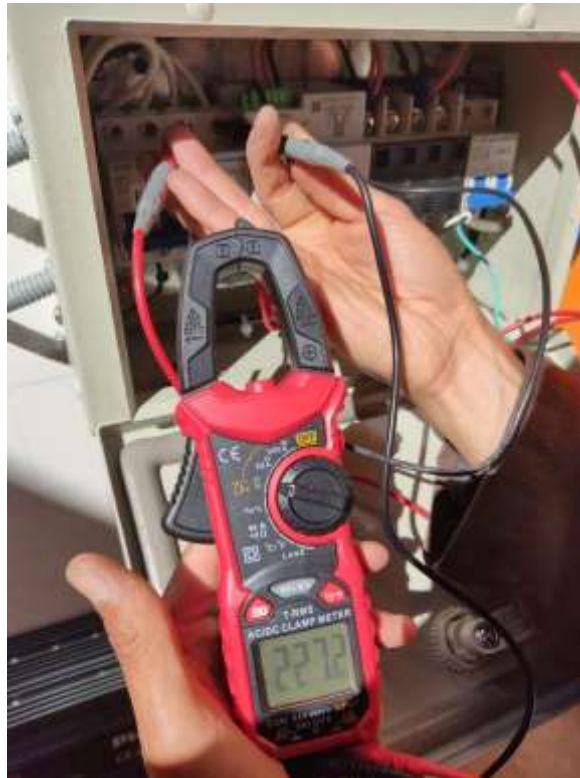
Imagen No. 39 Comprobación de voltaje en paneles Elaborado por: Cristian Daniel Suntasig Flores Fuente: Datos de la investigación
