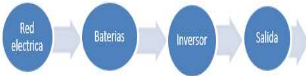
Gráfico No. 3 Estructura de funcionamiento UPS
