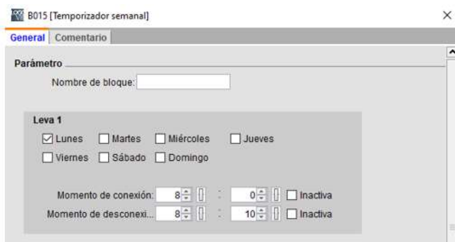
Imagen No. 62 Programación ON-OFF generador semanal Elaborado por: William Alexander Roldan Bastidas Fuente: Datos de la investigación
