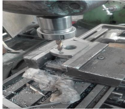
Figura 32. Perforación de agujeros equidistantes. Elaboración propia.
