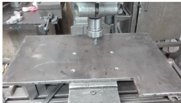
Figura 40. Fresado de agujeros ranurados. Elaboración propia.
