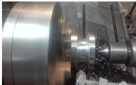
Figura 37. Ranurado circular. Elaboración propia.
