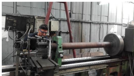
Figura 19. Cilindrado de rodillos. Elaboración propia.
