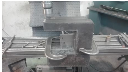
Figura 21. Montaje de las piezas en la fresadora. Elaboración propia
