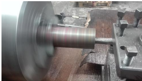
Figura 35. Mecanizado del buje. Elaboración propia.
