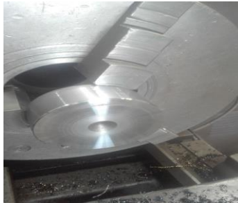
Figura 39. Cilindrado del espaciador. Elaboración propia.
