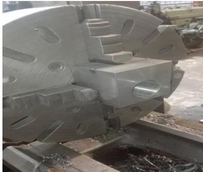
Figura 27. Montaje y centrado de la pieza. Elaboración propia.
