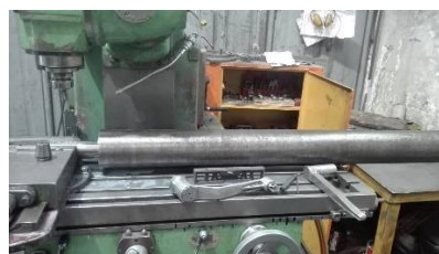
Figura 20. Montaje para construcción del chavetero. Elaboración propia.
