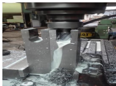
Figura 24. Ranurado con fresa de corte. Elaboración propia.
