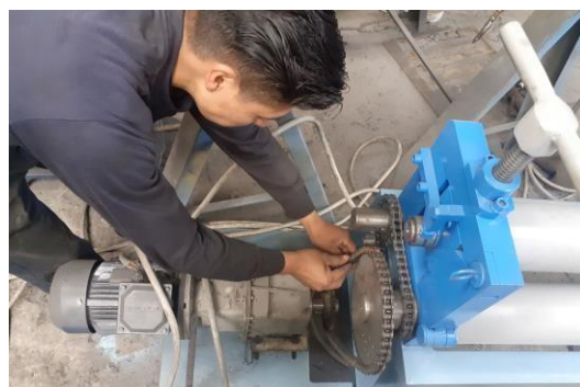
Figura 47. Instalación de los mecanismos de transmisión. Elaboración propia.
