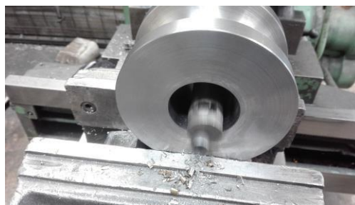
Figura 38. Mecanizado de chavetero. Elaboración propia.
