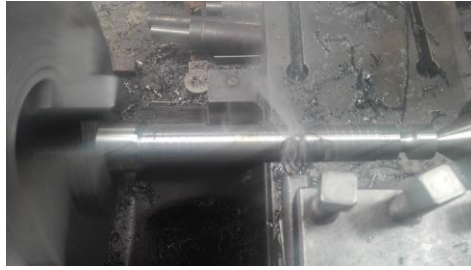
Figura 29. Construcción de rosca. Elaboración propia.
