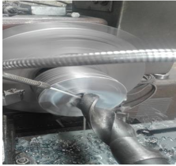
Figura 36. Perforación de la torta. Elaboración propia.
