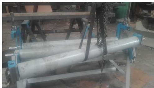
Figura 46. Ensamble de los rodillos. Elaboración propia.
