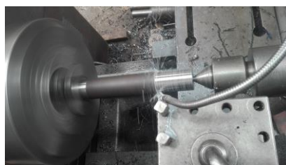
Figura 28. Cilindrado de diámetros. Elaboración propia.
