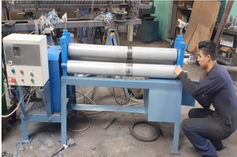
Figura 49. Máquina baroladora finalizada. Elaboración propia.
