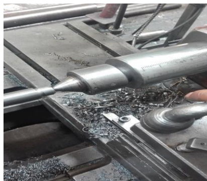
Figura 33. Cilindrado del pin. Elaboración propia.
