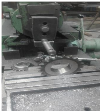
Figura 42. Mecanizado de chavetero en piñón. Elaboración propia.
