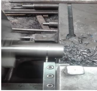
Figura 34. Cilindrado del pin. Elaboración propia.
